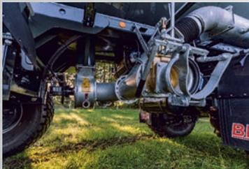
In der Grundausstattung verfügen die Transporter über einen mechanischen 6" Messingschieber mit nachgelagertem M-Teil System Perrot. Optional kann ein weiterer 6" oder 8" Schieber links oder rechts verbaut werden.
