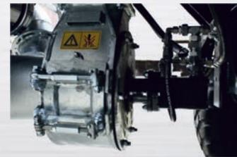
Zur effizienten Befüllung kann ein BRIRI Turbobefüller verbaut werden. Der über die Schlepperhydraulik angetriebene Beschleuniger verfügt außerdem über eine gut zugängliche Wartungsklappe, wo ohne großen Aufwand Fremdkörper entfernt werden können.
