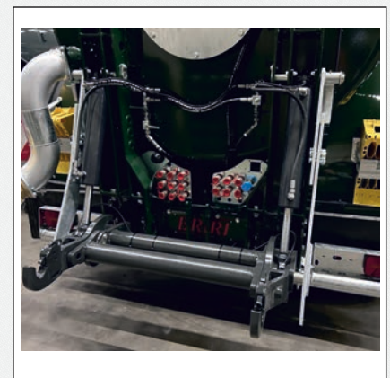
Hubwerk 5 Tonnen mit Pendelausgleich
