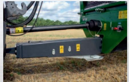
Die Verbindungsschläuche werden geschützt zum Zugfahrzeug geführt. Im abgekoppelten Zustand finden sie ausreichend Platz am Schlauchgalgen.
