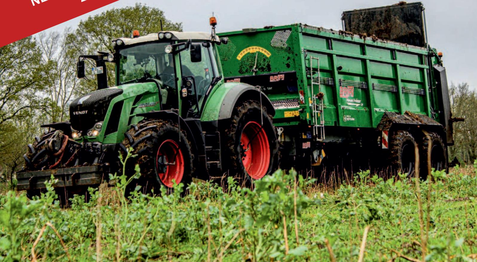
**BRIRI Manure Professor Großraumstreuer** – die Definition von Schlagkraft unter den Streuern! Der MP 20 / 22 oder 24 als Tandem sowie der MP 34 als Tridem. Der High Performer im Hause BRIRI. Das bewährte BRIRI Breitstreuwerk, optimiert mit einem Kardanantrieb verteilt Mist, Kompost, Klärschlamm oder Kalk auf einer Arbeitsbreite von bis zu 52m.
