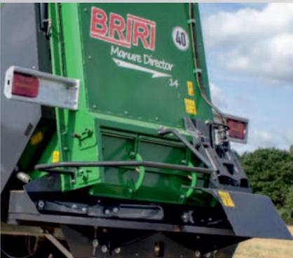
Die Streuwerkshaube ist mit PE-Platten ausgekleidet und schützt den Stahl so vor Beschädigungen und Korrosion. Eine zweigeteilte Dosierklappe lässt den Aufgabepunkt des Streugutes auf die Schaufeln optimal anpassen.
