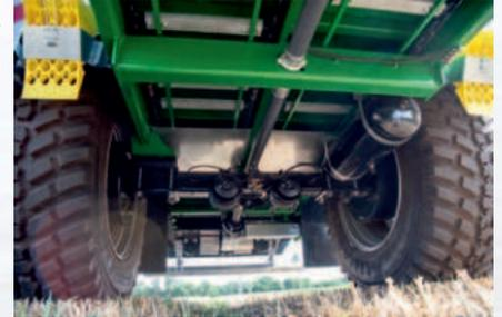
Ausgestattet ist der Streuer mit einer Deichsel zur Untenanhängung in K80. So kann die serienmäßig gefederte Einholmdeichsel Stützlasten von bis zu 4 t übertragen. Durch die schlanke Bauform wird ein maximaler Einschlagwinkel sichergestellt. Der mittig angeordnete Stützfuß gewährleistet einen sicheren Stand. Im angekoppelten Zustand der Maschine hebt sich der Stützfuß hydraulisch in die Deichsel und sorgt somit für keinerlei Behinderungen während des Feldeinsatzes.
