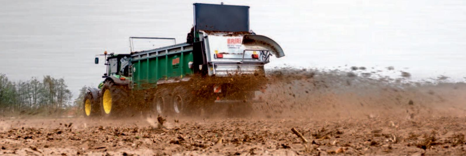
Das BRIRI Breitstreuwerk, welches serienmäßig verbaut ist überzeugt nicht nur durch die große Arbeitsbreite von 25m, sondern setzt auch Maßstäbe in punkto Querverteilung. Dieses wird durch die Rotoren erreicht, die ineinandergreifen und das Streugut lange führen. Für eine feine Zerkrümelung des Streugutes sorgen im Vorfeld zwei liegende Stufenfräswalzen mit aufgeschraubten Reißzinken, die doppelseitig nutzbar sind.
