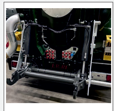
Hubwerk 5 Tonnen mit Pendelausgleich
